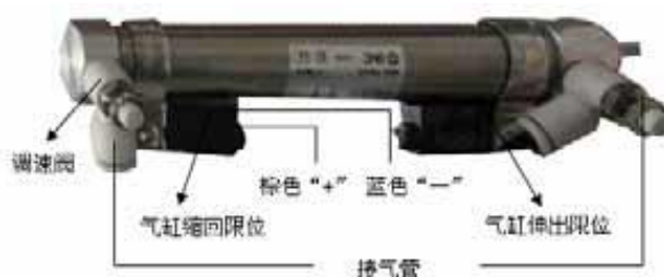
图 2.2.14 推料气缸示意图
