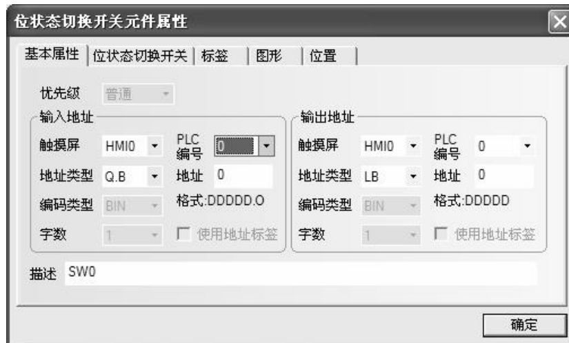
图 2.7.49 位状态切换开关元件属性
